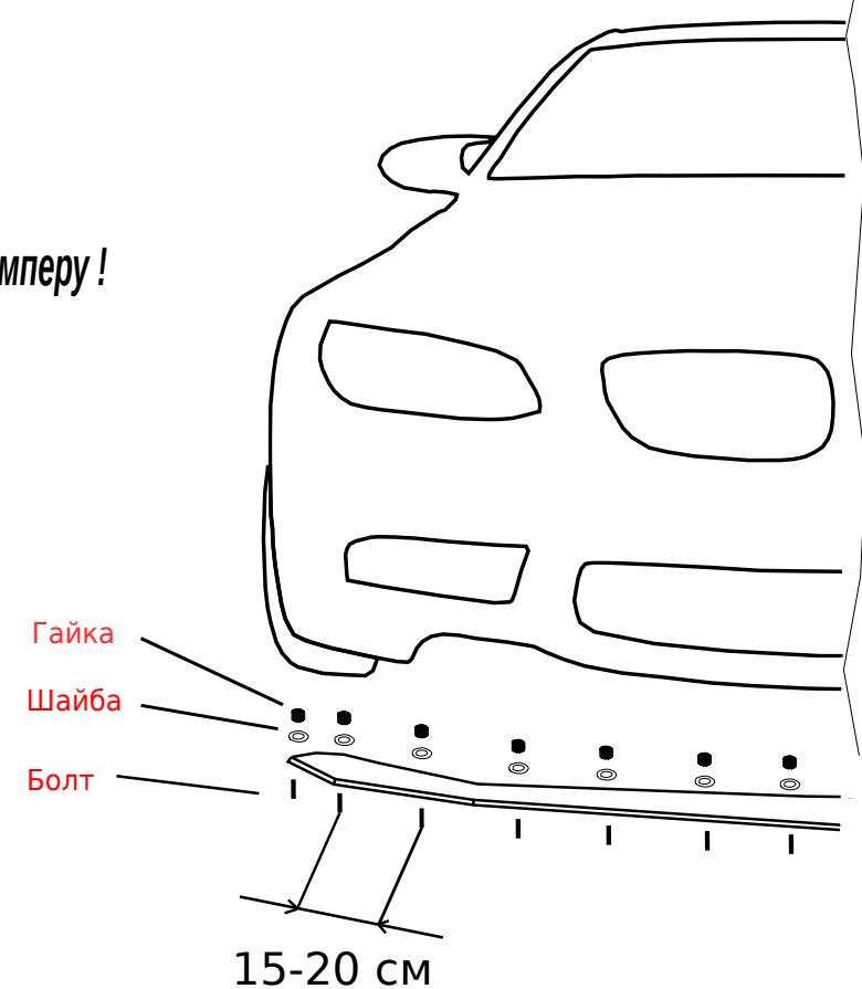
Внимание!!! При неправильной установке детали ветровая нагрузка на больших скоростях может оторвать сплиттер от бампера и нанести повреждения как Вашему автомобилю, так и другим участникам дорожного движения
