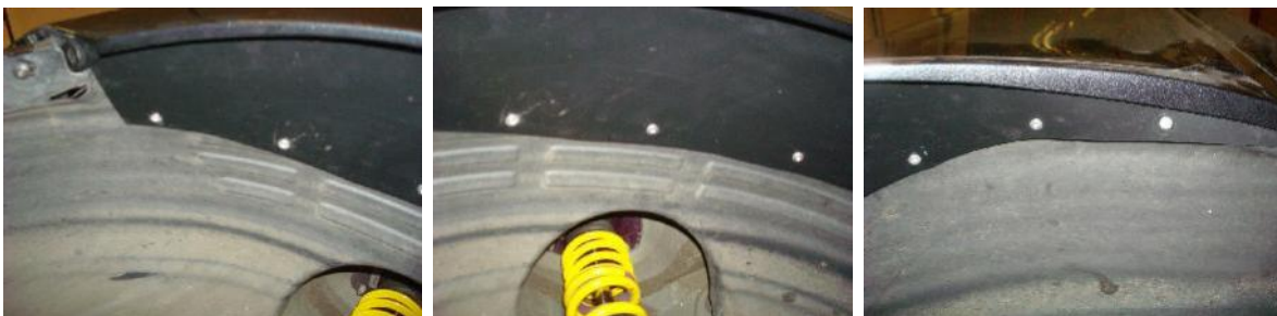
Abb. 18 – 20 Der Spalt zwischen dem Rest der Radhausschalen und den Kotflügeln wird mit den beiliegenden vorgefrästen Kunststoffplatten wieder geschlossen. Die Kunststoffplatten werden so eingepasst, dass sie an der Unterseite der zugeschnittenen originalen Radhausschale plan aufliegen und horizontal nach außen verlaufen.
