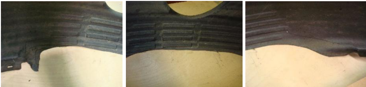
Abb. 15-17 Die originalen Radhausschalen sind an der Außenseite stark nach unten gezogen und enden bei der Radlaufkante. Dieser Bereich wird einem geeigneten Schneidwerkzeug abgesägt.
