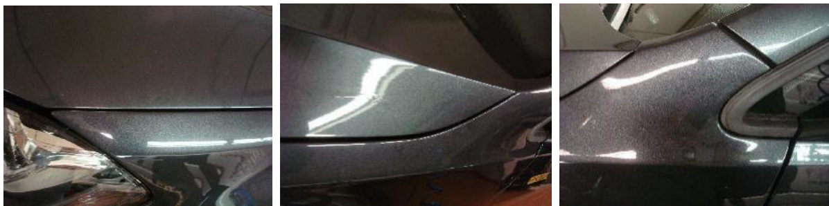
Abb. 2-4 Das Spaltmaß hin zur Motorhaube soll ca. 2-3 mm betragen.
