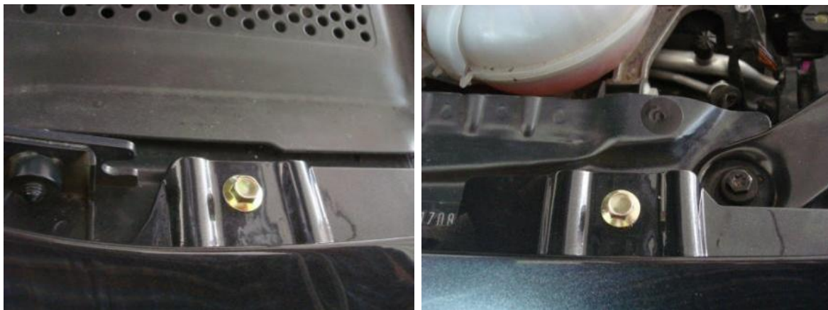
Abb. 7+8 Die originalen Kotflügelschrauben werden durch die beiliegenden Kotflügelschrauben (M6x18 mit angegossener Scheibe \varnothing 16mm) ersetzt.
