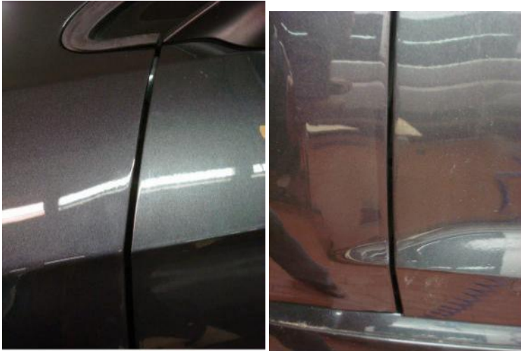
Abb. 5+6 Spaltmaß bei der Fahrer- Beifahrertür soll ca. 4 mm betragen.
