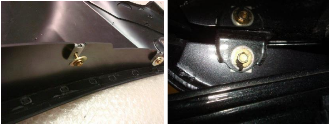
Abb. 9+10 Die Verschraubung bei den Halterungen im Bereich der A-Säulen erfolgt mit je 2 der beiliegenden Blechschrauben 4,8 x 20mm + Beilagescheiben 6/25mm und Blechmuttern 4.8.
