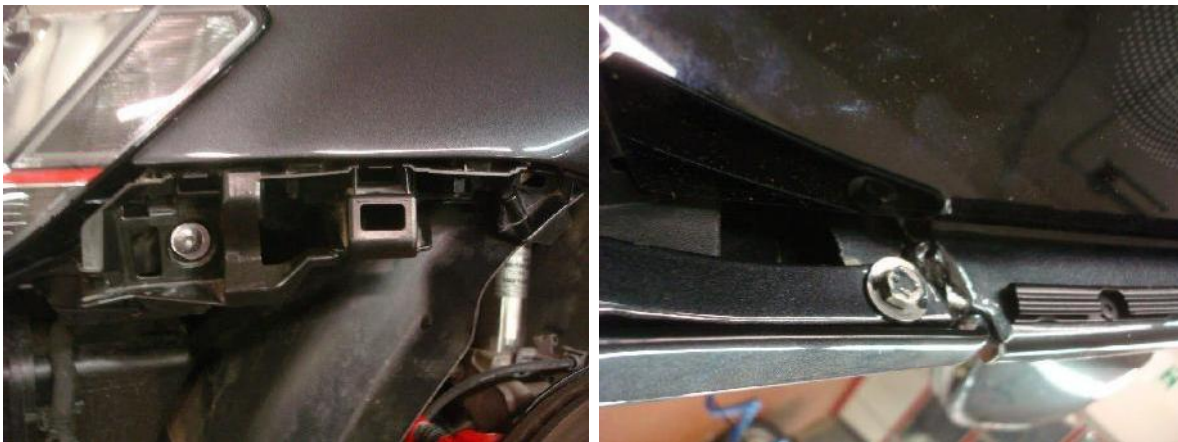
Abb. 11 Die Verschraubung im vorderen Bereich erfolgt mit dem originalen Zubehör.
