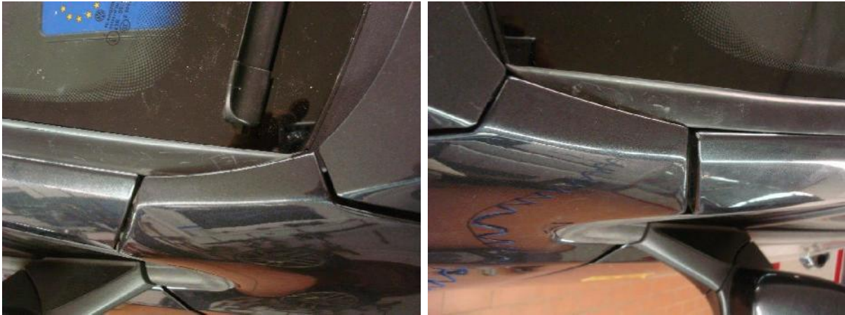
Abb. 13+14 Die Gummileiste wird wie original eingesteckt und am unteren Ende unter die Kotflügel geschoben.
