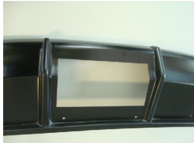
Abb. 2 + 3 Lösen der Sicherungsschrauben und entfernen der Abdeckung für AHK
