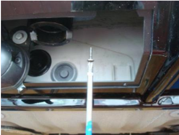
Abb. 12 zeigt Aussparung für AHK Bei Fahrzeugen ohne AHK wird der Heckeinsatz ebenfalls durch diese Aussparung verschraubt.
