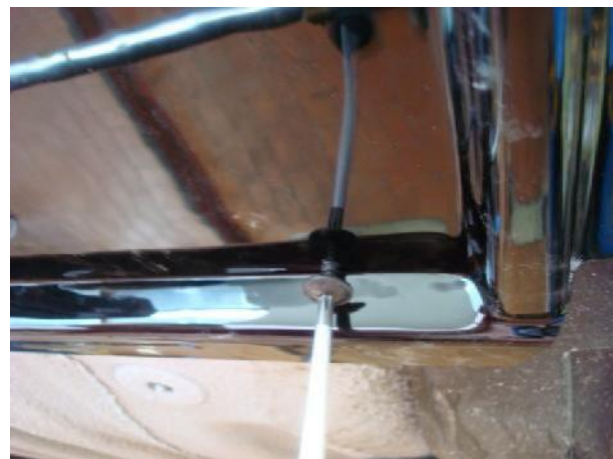
Abb. 8 + 9 Anbringen der 4 Stück Torxschrauben 5,0x16mm. Die Bohrungen dafür liegen bereits vor.
