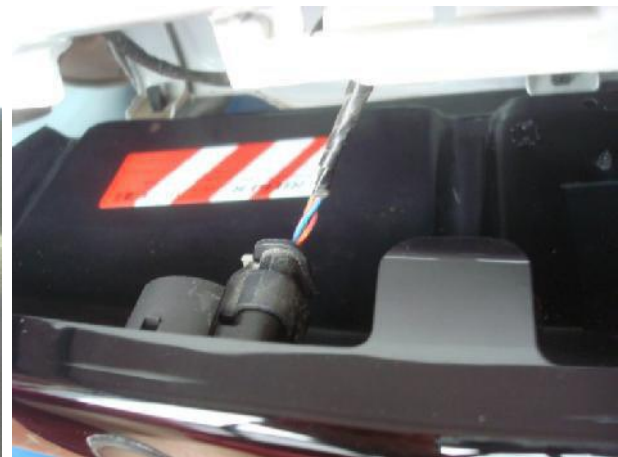
Abb.4 + 5 Montage der PDC-Sensoren im Heckeinsatz und PDC-Kabel anstecken für Funktionsprüfung (Nur bei Fahrzeugen, die PDC verbaut haben).
