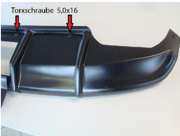
Abb. 8 + 9 Anbringen der 4 Stück Torxschrauben 5,0x16mm. Die Bohrungen dafür liegen bereits vor.
