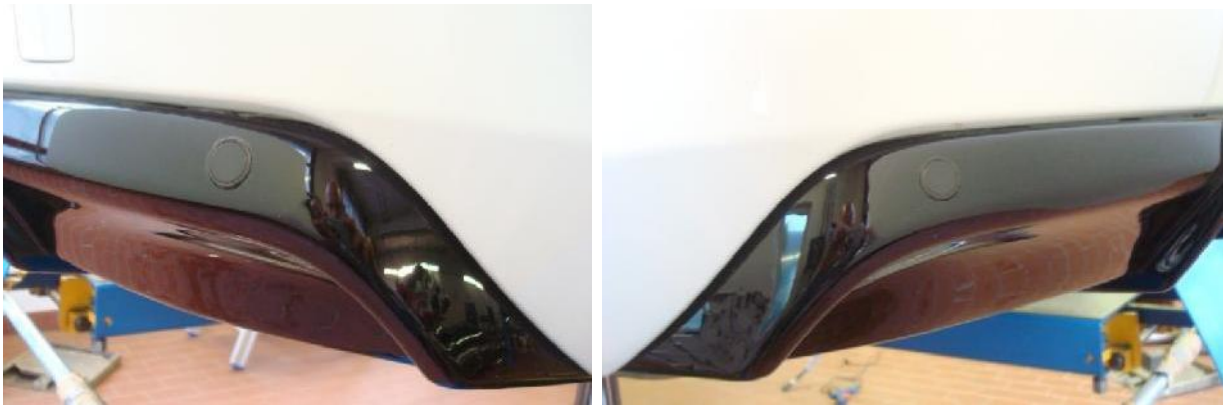
Abb. 6 + 7 zeigt montierten PDC-Sensor in Heckeinsatz (hier Ausführung ABS/schwarz-glänzend)
