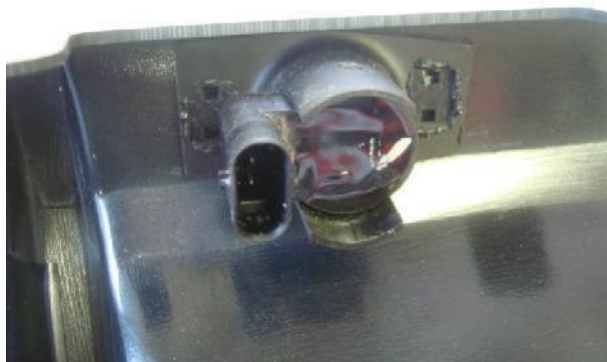
Abb.4 + 5 Montage der PDC-Sensoren im Heckeinsatz und PDC-Kabel anstecken für Funktionsprüfung (Nur bei Fahrzeugen, die PDC verbaut haben).
