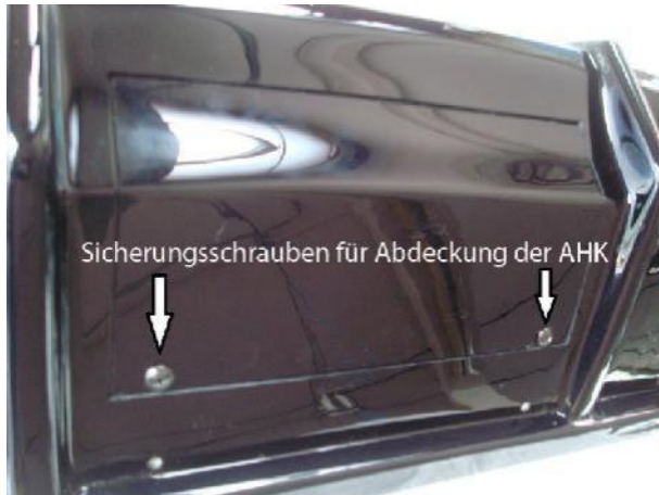
Abb. 2 + 3 Lösen der Sicherungsschrauben und entfernen der Abdeckung für AHK
