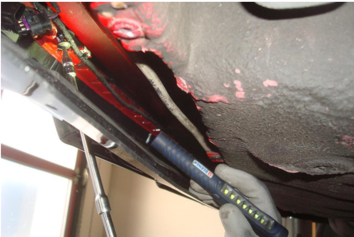
Abb. 9 Damit die 4 Stück Montagepunkte eingesehen werden können, muss der Heckeinsatz im mittleren Fahrzeugbereich etwas vom Unterboden des Fahrzeuges weggedrückt werden. Somit kann man mit einer Lichtquelle (z. B. Taschenlampe) den jeweiligen Montagepunkt ausleuchten um die 4 Stück Torxschrauben 5,0x16mm in den vorhandenen Bohrungen der Montagelaschen anzubringen wie bei Abb. 6 im Detail dargestellt.
