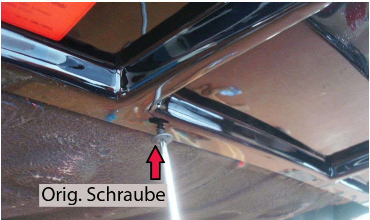
Abb. 12 Zur Befestigung an den 4 Stück mittleren Montagepunkten des Heckensatzes werden die 4 Stück orig. Schrauben (Torxschraube 5,0x16mm) verwendet, mit denen der orig. Heckensatz am Fahrzeug montiert war. Die Bohrungen im Heckensatz dafür liegen bereits vor. Am Fzg. werden dazu die orig. Montagepunkte verwendet. Beim Heckensatz ohne Endrohrblende sind hier evtl. 5 Stück Montagepunkte und 5 Stück orig. Schrauben vorhanden (Torxschraube 5,0x16mm).
