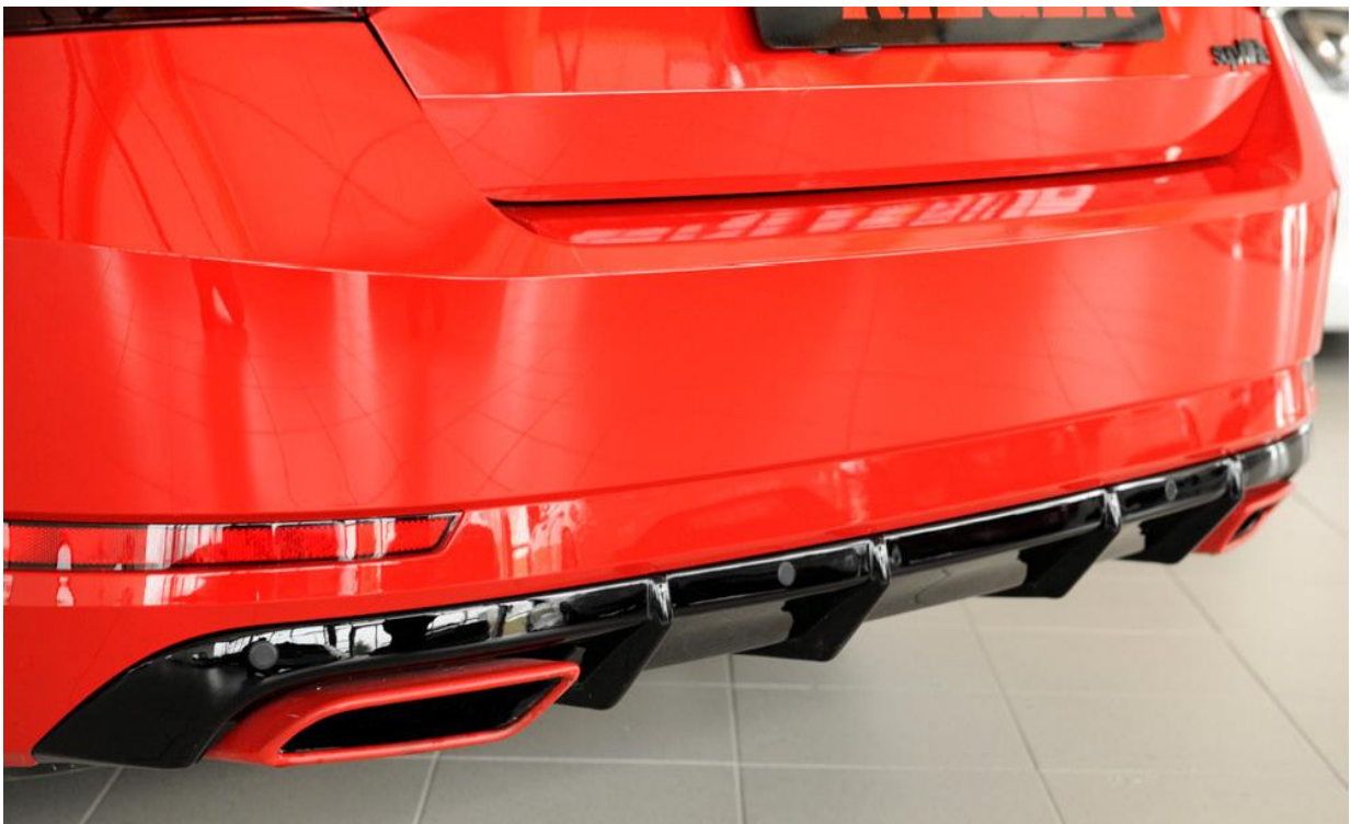
Abb. 18 Zeigt fertig montierten Heckeinsatz für Fahrzeug mit Endrohrblende links/rechts. Hier in der Ausführung „ABS/schwarz-glänzend“.
