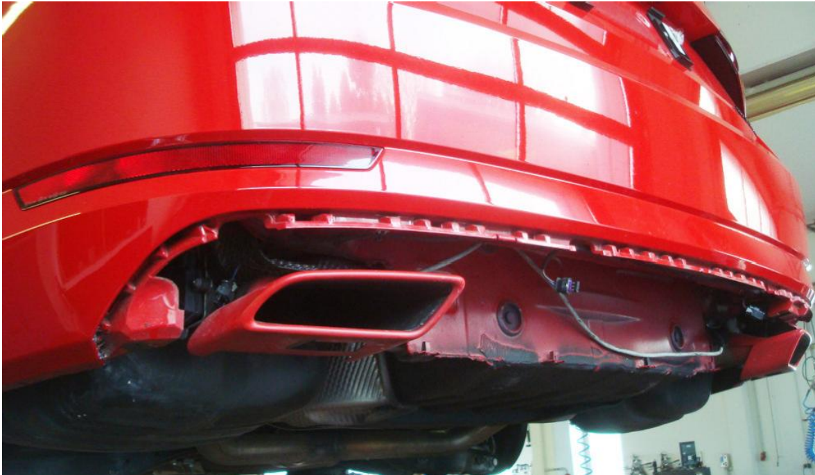
Abb. 3 Zeigt orig. Heckstoßstange ohne Heckeingsatz an Fzg. mit orig. Endrohrblenden (hier rot lackiert)
