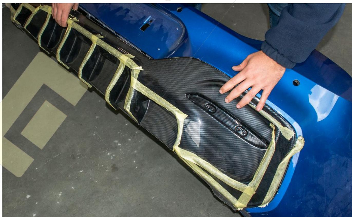
Так как на диффузоре вместо защелок только направляющие, то в направляющие с отверстием вкручиваются саморезы перпендикулярно направляющей.
